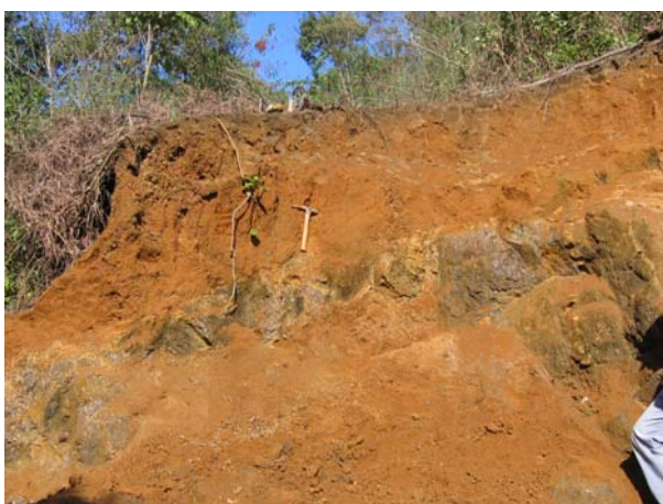
Depósito coluval (0,70m) sobre rocha pouco alterada.
