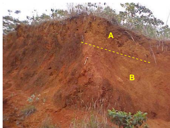
Perfil de alteração da unidade SHCV4: A – Solo residual (1,0m) B – Saprolito (8,0m)
