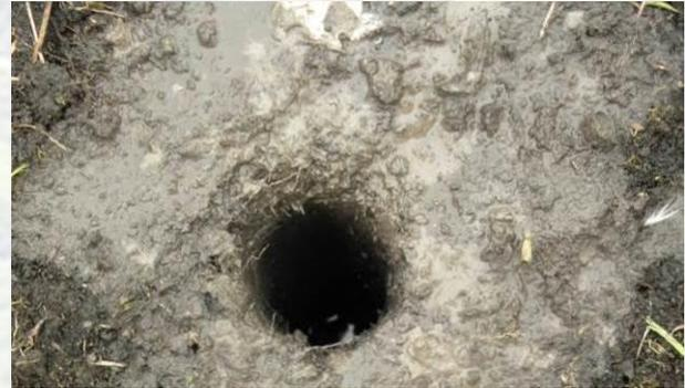
**Figura 5.30** - Detalhe do Furo 3 (ver posição nas figuras anteriores), com diâmetro de 3" e nível d'água a cerca de 0,3 m de profundidade.
