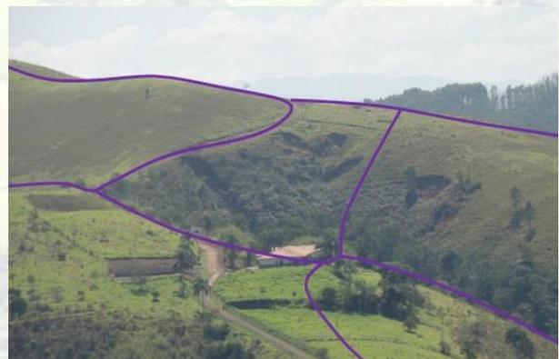
**Figura 5.7** - Exemplo de delimitação dos terrenos segundo o conceito de Unidade Homogênea de Terreno (UHT).
